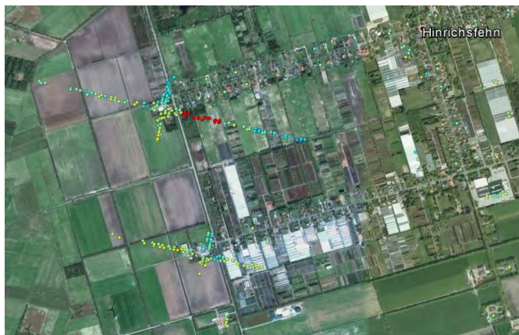
Die Zuverlässigkeit des PS-InSAR Verfahrens wird durch Qualitätskontrollen erhöht und sichergestellt. Im Bild, Beispiel für einen Sidelobe-Effekt in Hinrichsfehn , Wiesmoor, der im Rahmen einer Qualitätskontrolle entfernt wurde.
